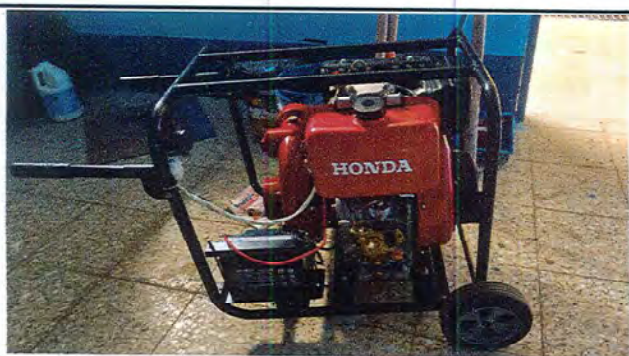
Foto 5: Se observa la Bomba de agua que se adquirió para la distribución del agua del tanque de la comunidad a los depósitos de agua de la escuela.
